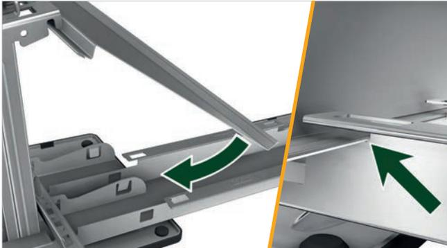
Enganche el borde superior de la placa deflectora de viento en el hueco del adaptador de cumbre y en la lengüeta de la parte inferior de la pinza intermedia. A continuación, fíjelo en la parte inferior con la abrazadera universal FLA.
