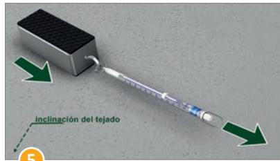
5 Tire de la pesa de prueba a través de la inclinación del tejado.
