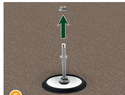
6 Obere Schraubenmutter lösen.
