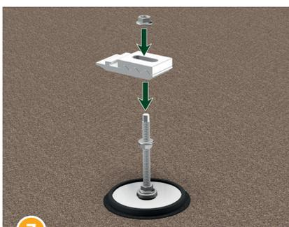
7 Stockschraubenaufsatz mittels der mittleren Mutter in der passenden Höhe für das Modul ausrichten und mit der obersten Mutter kontern.
