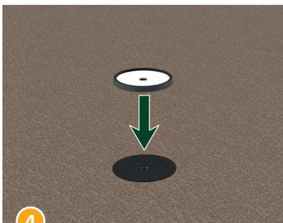
4 Die Dichtplatte mittig auf dem Bitu-Pad platzieren.
