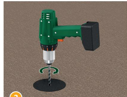
3 Bohrloch durch die Mitte des Bitu-Pad, rechtwinklig zur Dachfläche, durch das Dach in den Sparren bohren.
