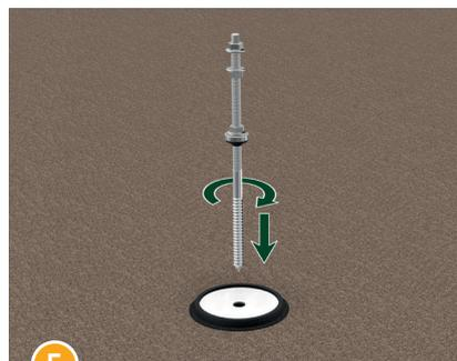
5 Stockschraube mit der Abdichtung (EPDM-Gummi) und der Druckkalotte mittig auf das Bitu-Pad aufsetzen und Schraube rechtwinklig einschrauben.
