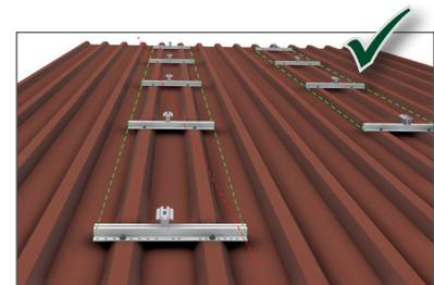
Die Trapezbefestiger immer parallel und möglichst in einer Linie anbringen
